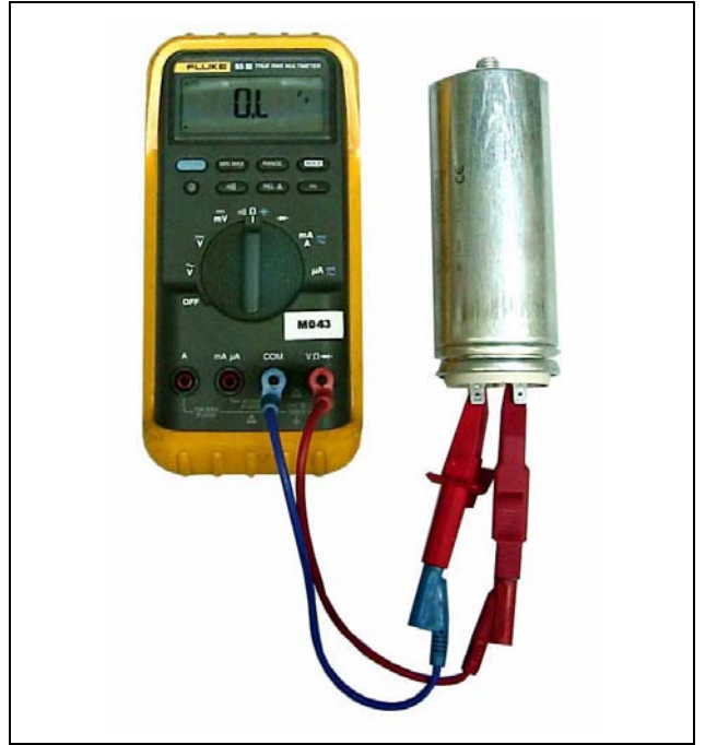
Fig. C.3.2-1: Checking the capacitor
